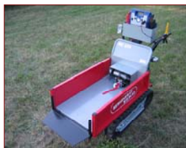
Die Seilwinde wird mit einer Batteriestation betrieben
