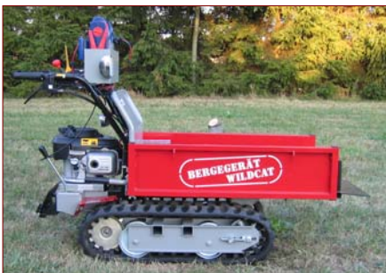
Der Raupenantrieb hilft alle Hindernisse zu überwinden.
